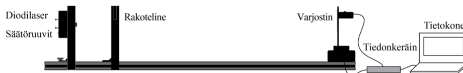
Kuva 2. Mittalaitteisto. Vasemmalla laser ja rakojärjestelmä ja oikealla varjostinlevy antureineen.
