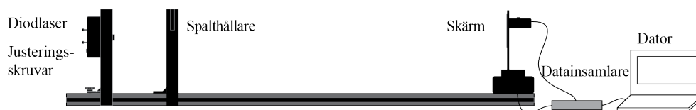
Figur 2. Mätapparaturen. Till vänster ses lasern och spaltsystemet och till höger skärmen samt detektorerna.
